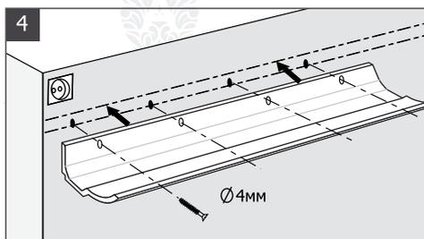
**4** Приложите изделие к стене, плотно прижимая его к поверхности. Зафиксируйте при помощи саморезов. Саморезы необходимо вкрутить, слегка утопив их в само изделие, а затем зашпательовать отверстия.
