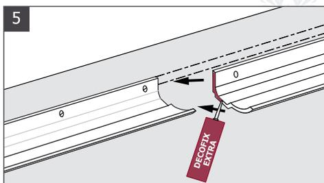
**5** Все элементы соединения между собой промазываются стыковочным клеем. Равномерно нанесите специальный клей для стыков «Decofix EXTRA» на одну из поверхностей с избытком, заполняя всю плоскость стыка. Состыкуйте с уже установленным изделием, выдавив лишний клей, максимально притягивая изделия друг к другу. Места стыков зафиксируйте скобами при помощи мебельного степлера. Следуйте общей инструкции по монтажу карнизов и молдингов
