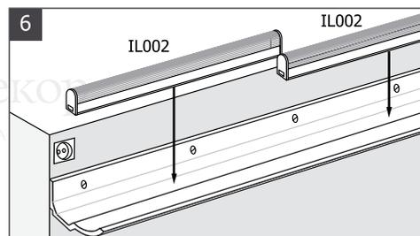
**6** После этого светильники могут быть установлены внутри карнизов. Установите первый светильник рядом с источником электропитания.
