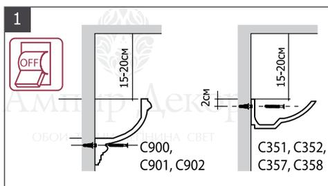
**1** Сделайте разметку с помощью отвеса или уровня в том месте, где планируется установка изделия. Идеальное расстояние между верхней частью короба и потолка – 15-20 см.
