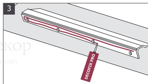
**3** Равномерно нанесите монтажный клей «Decofix Pro» на обратную сторону изделия.
