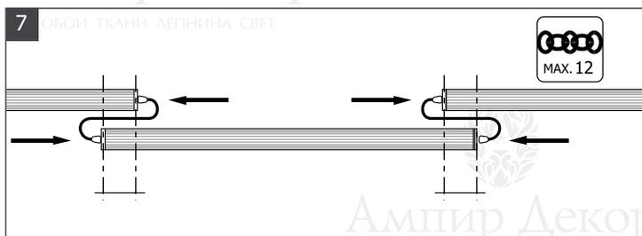
**7** Затем установите все остальные светильники. Соедините светильники между собой с помощью соединительного коннектора. Повторите предыдущие шаги до тех пор, пока не будет установлен последний светильник (максимум 12 элементов).
