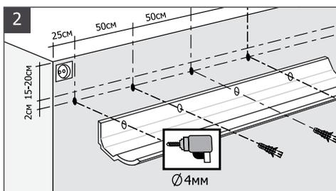
**2** Для прочной фиксации изделий и предотвращения сползания на момент высыхания клея (24 часа) используйте саморезы. Для этого просверлите изделие под саморез, достаточно четырех отверстий. Отметьте на той поверхности, где планируется установка изделия, места под дюбеля, используя ранее просверленные отверстия в изделии.
